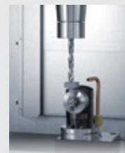
\*3 主軸ベアリングにセラミックボールを使用した高速主軸を装備しています。そのため、通電式のタッチセンサを使用することはできません。
