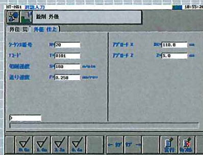
面粗さを設定することで加工条件が自動入力されます。
