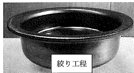
図3 予備絞り工程から絞り工程のトライの様子
